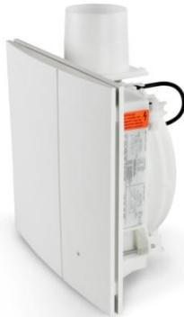
Der Klemmlüfter A80-TKL mit seitlichem Abluftstutzen ist für den Einbau in Sanitärzellen oder in Leichtbau-Plattenverkleidungen mittels Klemmbefestigung vorgesehen.
