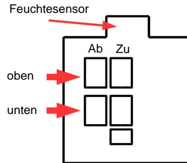
Zu- und Abluft bezieht sich auf die Startrichtung bzw. auf den Stoßluftbetrieb. Ein Lüfter, der auf der Zuluftseite angeschlossen ist, wird bei der Stoß- oder Dauerluftfunktion entsprechend im Zuluftmodus arbeiten, ein Lüfter, der auf der Abluftseite angeschlossen ist, fördert entsprechend Abluft.
