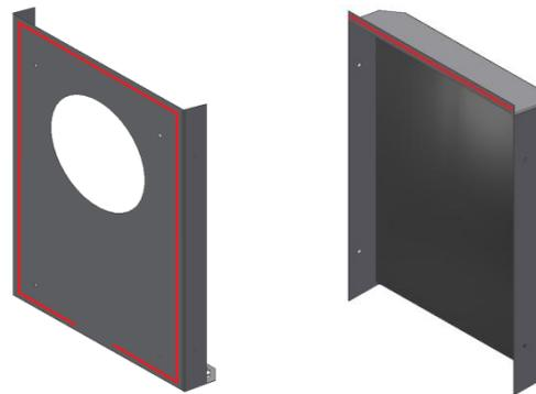
2. Waagrechtes Anbringen des Unterteils an der Fassade. Dazu das Unterteil auf das überstehende Fixrohr setzen, mit Wasserwaage ausrichten, Bohrungen anzeichnen und mit Dübeln und Schrauben befestigen.
