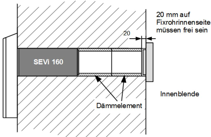
Die Dämmelemente werden **nach dem Einschub** des Lüfterantriebs im Fixrohr platziert. (Für die erforderliche Länge der Schalldämmung sind von der Länge des eingepassten Fixrohres 260 mm abzuziehen.)
