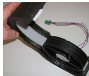
Bei Nichtbetrieb des Lüftersystems kann die Innenblende durch 180° verdrehte Montage des Oberteles der Innenblende verschlossen werden.
