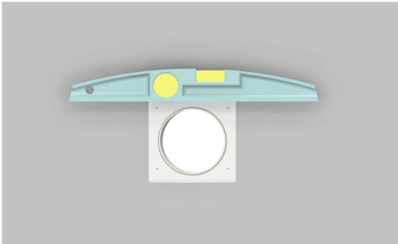
**11. Waagrechtes Anbringen** des Unterteils an der Fassade (Abtropfkante nach unten außen). Dazu das Unterteil auf das überstehende Fixrohr setzen, mit Wasserwaage ausrichten, Bohrungen anzeichnen und mit den Wandaufbau geeigneten Dübeln und Schrauben befestigen.
