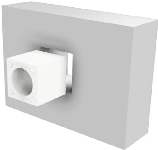
**3. Optional: Verwendung des Rohbauträgers,** erstellen des Wanddurchbruchs. Fixrohr bei Bedarf mit einem für PP und EPS geeignetem Montagekleber im Rohbauträger fixieren! Rohbauträger mit einem Gefälle von innen nach außen von 1-2° einsetzen!
