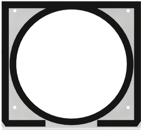
**10. Anbringen des Quellbandes** auf der Rückseite des Unterteils der Wetterschutzhaube (Ausgleich zwischen Wand und Unterteil). Im Unteren Bereich ist mittig ein Abstand von ca. 60 mm freizulassen. Das innere und das äußere Quellband dürfen sich in diesem Bereich nicht berühren!
