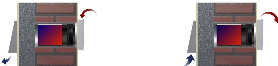
Prinzip der Wärmerückgewinnung
