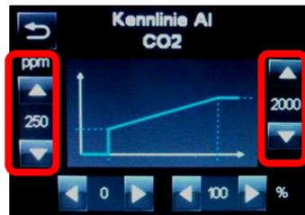
Bei der Verwendung von Feuchte- oder Temperatursensoren wird in gleicher Weise vorgegangen.
