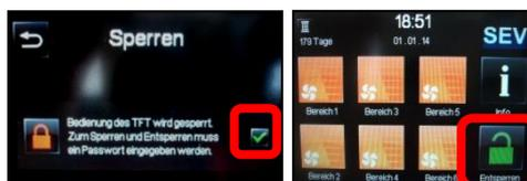
Es wird weiterhin die Übersicht der aktuell eingestellten Lüfterzustände angezeigt. Über das Schloss-Symbol kann der Entsperrcode eingegeben werden (11111).
