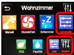
Zum Programmieren der Zeitautomatik ist der gewünschte Bereich auszuwählen. Unter "Automatik" öffnet sich das Belegungs Menü für die Zeitsteuerung. Zum Festlegen der einzelnen Schaltzeiten muss das Menü Zeitprogramm unter "Ändern" geöffnet werden.
