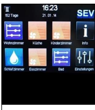
Das Ende der Schaltzeit wird durch den Beginn der darauffolgenden Schaltzeit bestimmt. Nach Abschluss der Einstellungen wird die eingestellte Schaltzeit durch das Setzen des grünen Hakens aktiviert. Im Ausgangsbildschirm sind dann die Bereiche mit dem Symbol der Zeitautomatik versehen. Eine manuelle Änderung ist jederzeit möglich. Die Zeitautomatik wird dann deaktiviert. Um die Lüfter wieder im Zeitmodus
