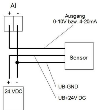
Zur Verwendung mit der Steuereinheit SEC-Touch empfohlene **aktive** Sensoren:
