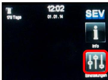
Der Ausgangsbildschirm zeigt vorerst nur die Zeit bis zum nächsten Filterwechsel, Datum und Uhrzeit an. Der Bereich der Lüftungssteuerung ist noch nicht eingerichtet. (siehe 2.2.2)
