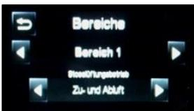
Bei Auswahl von **Nur Zuluft** oder **Nur Abluft** fördern alle im Bereich angeschlossenen Lüfter entsprechend. Bei der Auswahl **Zu- und Abluft** fördern sie gemäß ihres Anschlusses (**Startrichtung**) an der Steuereinheit (**A = Zuluft, B = Abluft**).
