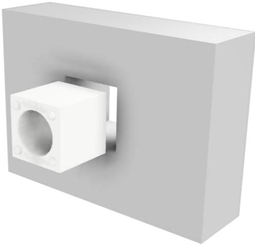
**3. Optional: Verwendung des Rohbauträgers,** erstellen des Wanddurchbruchs. Fixrohr bei Bedarf mit einem für PP und EPS geeigneten Montagekleber im Rohbauträger fixieren! Rohbauträger mit einem Gefälle von innen nach außen von 1-2° einsetzen!
