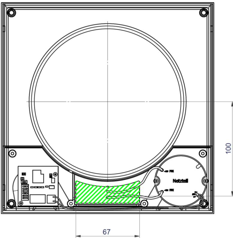
**4. Der Anschluss bzw. die Übergabe der 230 Volt Versorgungsspannung** erfolgt in einem ca. 65 mm breiten und 15 mm hohen Bereich, dessen Zentrum 100 mm unterhalb des Mittelpunktes der Kernlochbohrung liegt.
