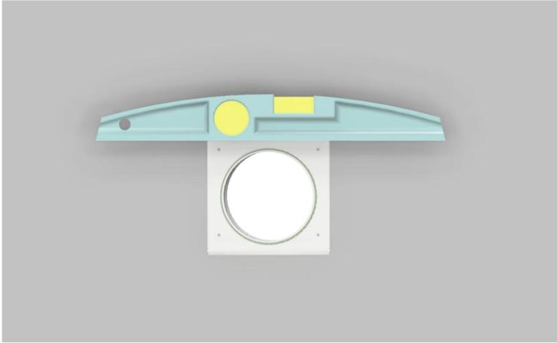
**10. Waagrechtes Anbringen** des Unterteils an der Fassade (Abtropfkante nach unten außen). Dazu das Unterteil auf das überstehende Fixrohr setzen, mit Wasserwaage ausrichten, Bohrungen anzeichnen und mit den Wandaufbau geeigneten Dübeln und Schrauben befestigen.
