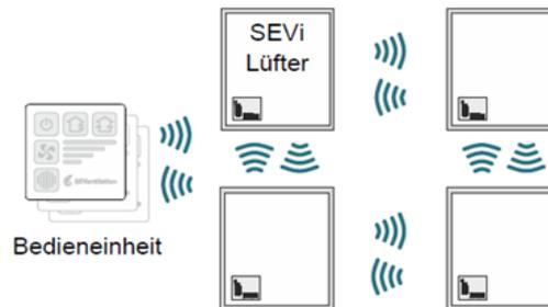
Die Bedieneinheit steht mit dem Master in Kontakt. Über die BDE erhält der Master seine Befehle, die er dann an die Slaves weitergibt. Durch die wechselseitige Kommunikation zwischen einzelnen Modulen (Master/Slave oder Slave/Slave) ist eine flächendeckende Einrichtung des Netzwerkes möglich, da auch von einem Slave empfangene Signale der BDE an den Master, und somit an die restlichen Slaves, übermittelt werden.
